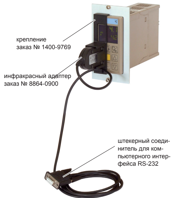
Рис. 4: Подключение инфракрасного адаптера
